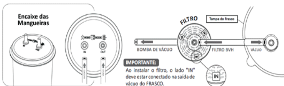
Fig. 02 – Tampa do frasco e ligações das mangueiras de silicone
