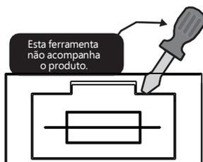
**ATENÇÃO:** Para realizar a troca do fusível, garanta que o seu produto esteja desligado da tomada. Na ocorrência de queima do fusível de proteção o mesmo deve ser substituído. Para realizar a troca do fusível retire o porta fusível utilizando uma ferramenta, conforme figura ao lado.
