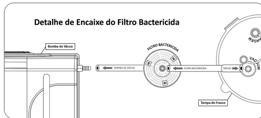
Fig. 07 - Encaixe do filtro bactericida
